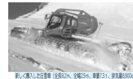
新しく購入した圧雪車(全長9.2m、全幅2.5m、車重7.3t、排気量8,900cc)
