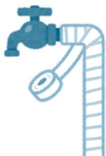
水道管を保温材で覆っておくと、水道管を冷たい外気から守ることができ、水温の低下・水道管の凍結を防ぐことができます。
