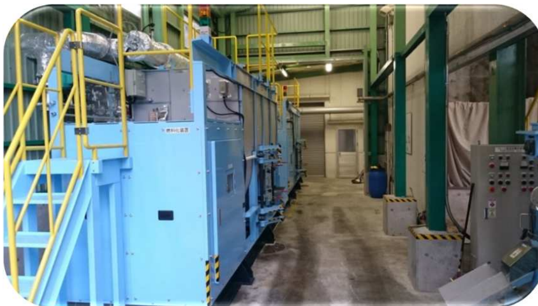
紙おむつ燃料化装置 (手前が2号機)
