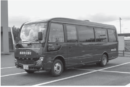
▲3～5分で室内の空気を入れ替えることができる換気機能付き小型バス
